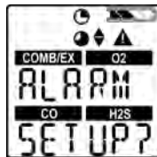
Figura 3-4. Configuración de alarma
